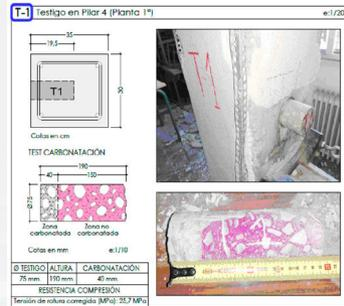
Extracción de probetas testigo y test de fenoltaleína en pilares
