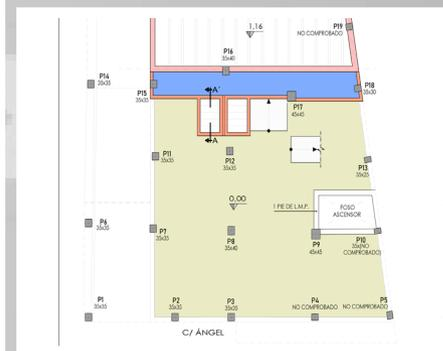
Se realiza un reconocimiento y evaluación de la estructura del edificio, se incluyen aperturas de calicatas, ensayos de penetración dinámica DPSH, extracción de testigos, pruebas de carbonatación, estudio esclerométrico y con ultrasonidos, apertura de calos y prueba de carga
