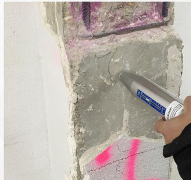
Ensayo con esclerometro y detección de disposición y tipología de la armadura
