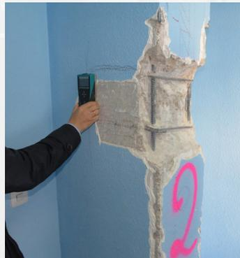
Detección de armaduras de la estructura con Pachómetro
