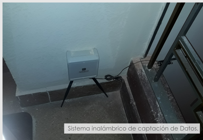
Clinómetro instalado en fachada.
